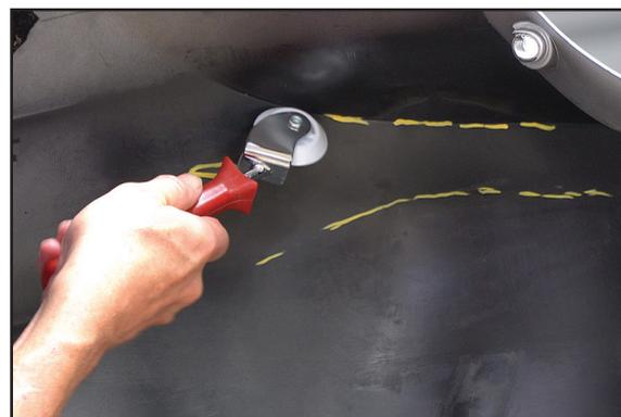
作業例 凹み部バンパープレスラインをマーカーペンなどでケガキ、ボデーラインローラーでプレス部を修正
