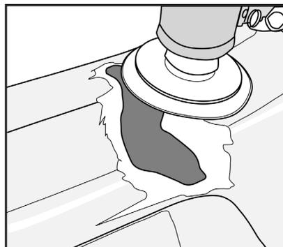
2液型の補修材料を使用すると、研磨を開始する前に少なくとも20分、場合によっては一晩待機する必要があります。Polyvanceの溶接システムを使用すると、必要に応じて、すぐに作業が完了できる為、修理にかかる時間を大幅に短縮できます。
