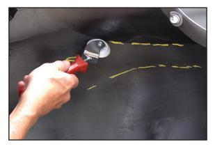
作業例 凹み部バンパープレスラインをマーカーペン などでケガキ、ボデーラインローラーでプレス部を修正
