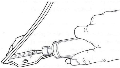
3. 先細りのリユータービットを使用して、コーナーに沿ってプラスチックを研磨します。溶接後、コーナー溶接ロッドが平らになるように、コーナーの両面でプラスチックを研磨します。バンパーを適切に取り付けるには、フランジの寸法と位置を維持することが非常に重要です。
