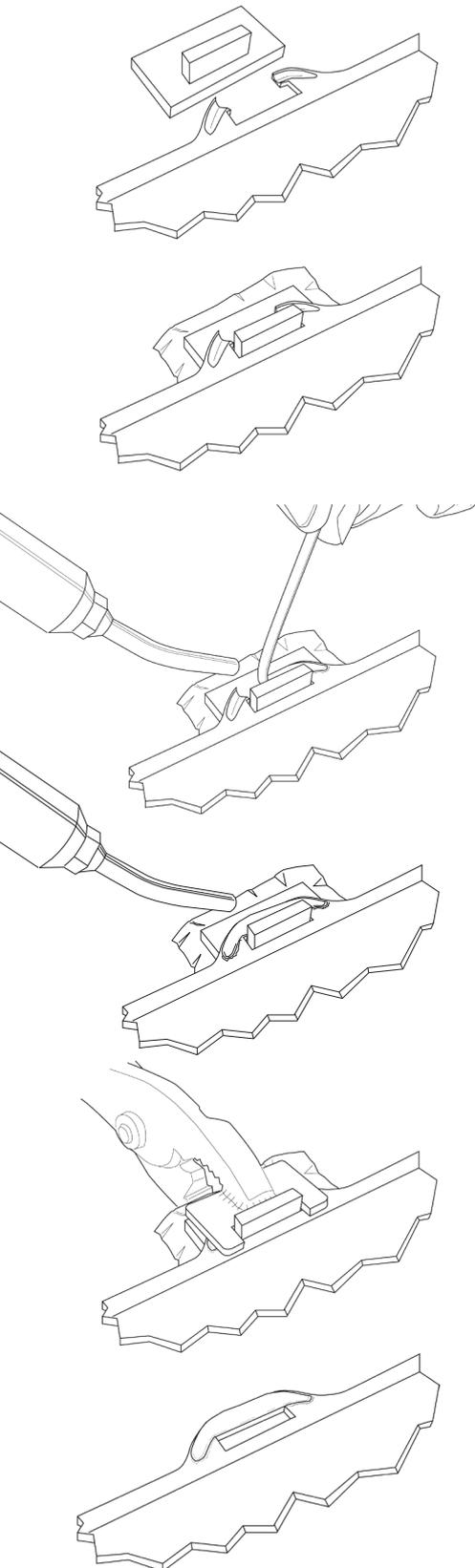
この損傷は、最近のバンパーでよく見られる損傷です。最大の強度を得るために、R02-08コーナー溶接ロッドを使用することによって、修復が可能です。多くのバンパーには、フェンダーとクォーターパネルのブラケットにはまるバンパーのエッジに薄いフランジがあります。これらは非常に薄いため、エッジに沿って裂けることがよくあります。これらのフランジは、接触面積が非常に小さいため、2液型接着剤を使用して修理することは非常に困難です。窒素プラスチック溶接機は、融合溶接プロセスの固有の強度のおかげで、ここで信頼できる修理を行うことができます。
