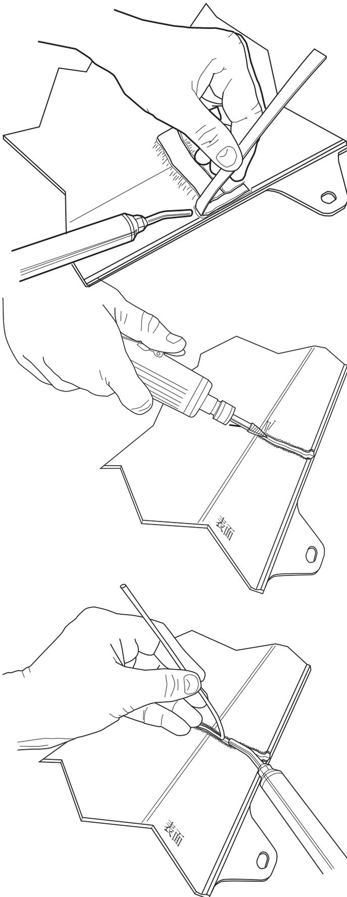
「ティー」を溶接します。亀裂の溶接が完了したら、補修を強化するために、縁に沿って亀裂の終わりに別のクロス溶接をすることをお勧めします。(T工法)
