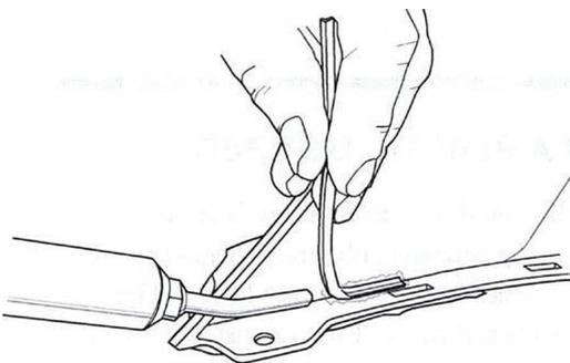
4. 窒素溶接機を使用して、コーナー溶接ロッドを使用して裂け目に沿って内側のコーナーを溶接します。このロッドは、バンパーに接触する前にロッドを柔らかくするために少しだけ熱を加えると、よりよく溶接されます。溶接ノズルの位置がよりロッドに集中していることに注意してください。亀裂に沿って溶接します。溶接後まだ熱いうちに、ホットエアレス溶接機で平らにします
