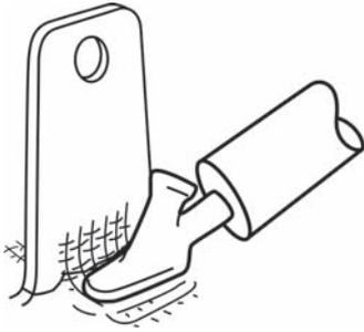
・ PP, TPO, TE0の引き裂かれたボルト穴をFiberFlexで修復する
