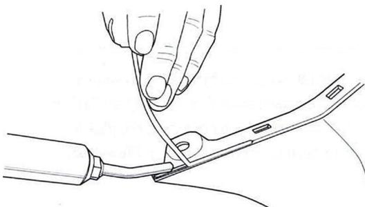
5. 通常、引っ張り強度を確保するには、コーナー溶接ロッドを使用した片側修理で十分です。塗料の損傷の可能性を最小限に抑えるために、フランジの外面での溶接は避けてください。外面を溶接する必要がある場合は、亀裂に沿ってタイトなV溝に直径3cmの丸ロッドを使用します。フランジを真っ直ぐに引っ張った時に、完成した修理は優れた強度を持っているはずですが、オリジナルのバンパーのように、フランジは上下に曲げられたときに大きな強度を発揮するようには設計されていません。
