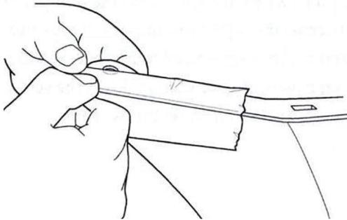
2. アルミニウムテープを外側のバンパーに非常にしっかりと貼り付けて、引き裂かれたフランジを所定の位置に固定します。バンパーのエッジに沿ってスロットがある場合、アルミニウムテープがスロットにできる限りぴったりと適合するようにします。背面の溶接部が前面を吹き飛ばさないようにし、必要に応じて二重層を適用してフランジがしっかりと保持されるようにします。
