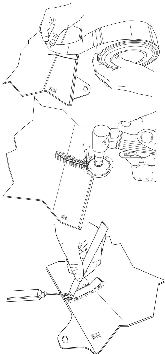
**表面（化粧面）を合わせます。**多くの場合、プラスチックは損傷した領域で引き伸ばされたり歪んだりしています。溶接する前に、亀裂をできるだけ揃えるようにしてください。プラスチックがへこんだり伸びたりしている場合は、ヒートガン等で加熱し、プラスチックを元の位置に押し戻し、亀裂部の面を揃うように修正します。表面に6481-1または6485アルミニウムテープで固定し面を整わせ裏面を溶接後、表面を揃えて溶接出来ることは、パテ充填の必要性を最小限に抑えることが出来る最善の方法になります。
