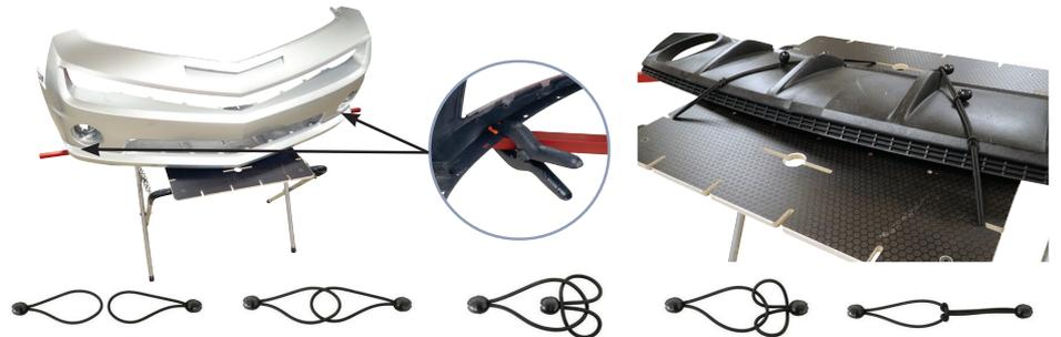
4. クレードルを使用するには、パーツを支持するために必要なクレードル間の距離を図り、クレードルのステムを回しながら、上部5つの穴の1つに押し込みます。必要に応じてクレードルを回してパーツを支え、次にバンジーをパーツの上に置き、両端をクレードルの下向きの端に引っ掛けます。
