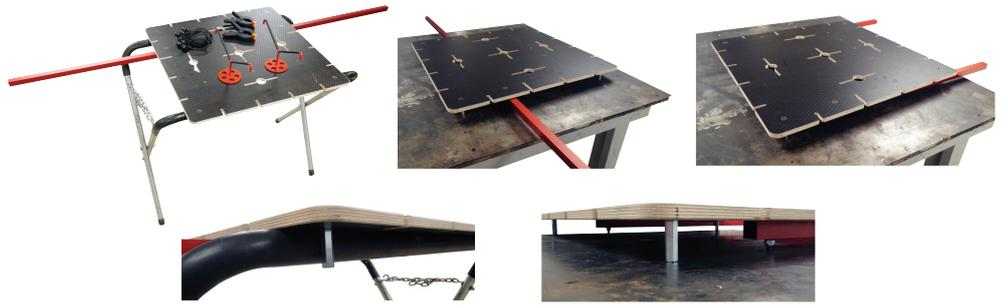
2. アームの角度を調整して、バンパーやその他の修理部品を最大限にサポートします。「A」クランプを使用して、バンパーカバーのリップをアームにクランプします。
