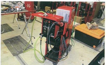
1 使用機材は、ポリバンス社製窒素プラスチック溶接機（窒素発生装置付き）8203-J
