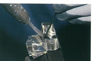
6 溶接トーチを近づけて、母材と溶接ロッドを溶かしていく。トーチが遠過ぎると窒素シールドガスの効果が弱まるため、溶接箇所に近づけるよう意識する
