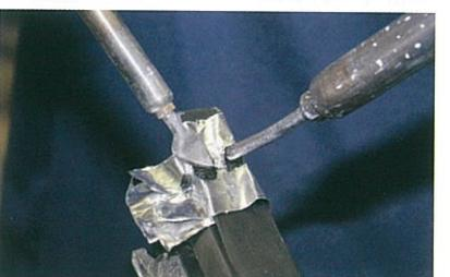
7 窒素を吹き付けながら、溶接チップ（コテ）を施工箇所に押しつけて、強度を高めつつ形状を整えていく
