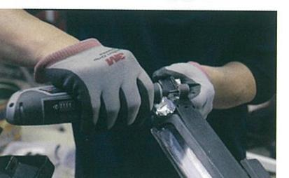
8 施工箇所にエアを吹き付けて温度を下げた後、アルミテープをはがしてサンダーなどで表面を研磨する。この後、側面及び背面に対しても同様に、アルミテープ貼り付け、溶接、サンディングを行う
