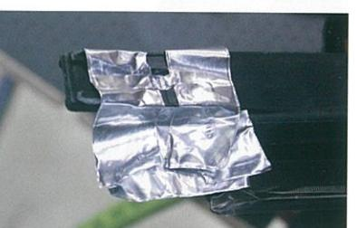
3 脱脂・清掃後、アルミテープを使用して、折れたステーを元の位置に固定する。熱からの保護を目的として、溶接箇所の周辺にもアルミテープを貼り付ける
