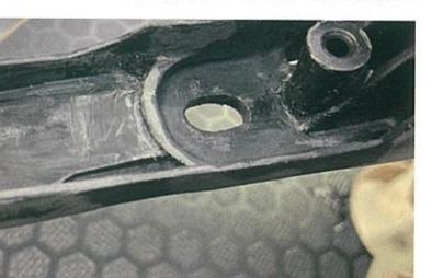
9 溶接作業完了後、プラサフを塗布して180番のペーパーで研磨した。この後はさらに番手を上げてサンディングし、専用塗料で外観を仕上げていく
