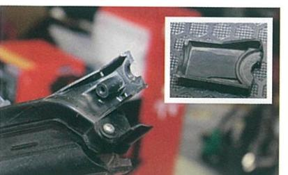
2 ヘッドライトステーをエアソーで切断し、折れた状態を再現した
