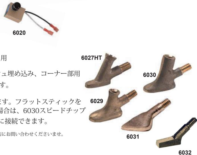
標準の直径3mm溶接ロッドの場合、6027HTまたは6029を選択します。フラットスティックを使用している場合は、6031を選択します。直径5mmの丸ロッドの場合は、6030スピードチップを使用します。ポリバンスのすべてのエアレスヒーターエレメントに接続できます。
