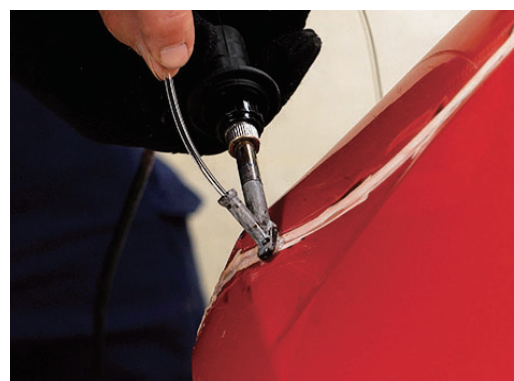
エアレス溶接機を使用して、ホットエア溶接による溶接部の平滑化や、付属の溶接ロッドを使用して熱硬化性ポリウレタン (PUR) バンパーやトラックベッドサイドの修理を行います。
