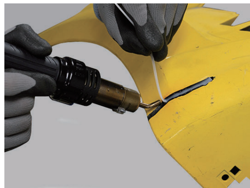
ホットエア溶接機を使用して、付属のリボンロッドを使用して、熱可塑性プラスチックに迅速かつ強力な溶接を行います。
