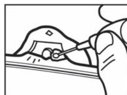
PlastiFixパウダー/リキッド混合物で型を満たし、30分間硬化させ、型を取り外します。
