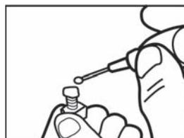
PlastiFix粉末/液体混合物をねじ山に塗布します。
