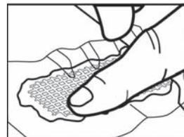
プラスチックシートで覆い、プレスして形を整え、硬化させます。
