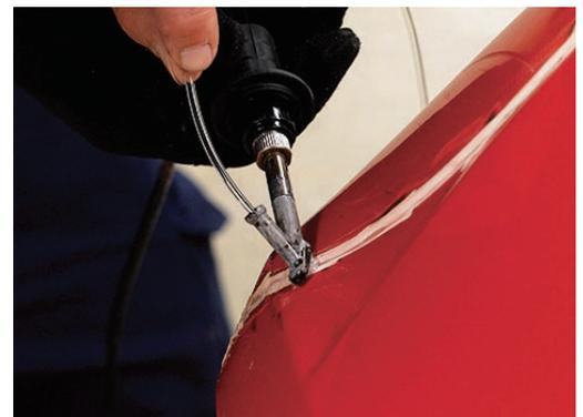
エアレス溶接機を使用して、ホットエア溶接による溶接部の平滑化や、付属の溶接ロッドを使用して熱硬化性ポリウレタン (PUR) バンパーやトラックベッドサイドの修理を行います。
