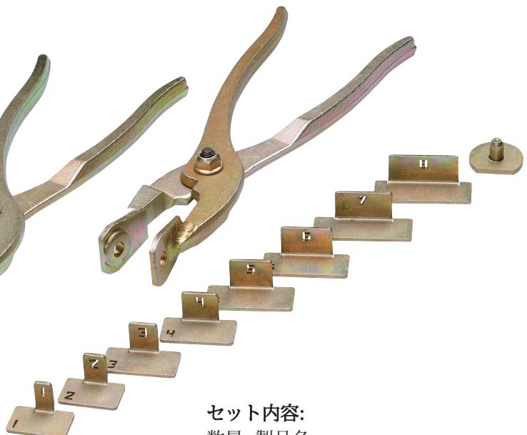
ポリバンス 6246 タブセーバーキットは、バンパーカバー、ヘッドライト、フェンダーライナーなどに見られる長方形スロットタブや埋込み穴の修理を、迅速かつ簡単に行えるよう設計されています。これらのタブは構造的に弱く、軽微な衝突や取り外し作業時に破損しやすい部分です。タブセーバーを使用することにより、破損箇所の補修が簡単に行えます。従来、窒素プラスチック溶接機を使ってスロットタブを修復する作業は、技術と繊細な手作業をする上に、時間もかかるものでした。さらに、スロットの正確な寸法を復元することが困難であり、パネルの正しい取り付けに支障をきたすこともあります。タブセーバー を使用することにより、高精度なタブ修理が簡単に実現できます。
